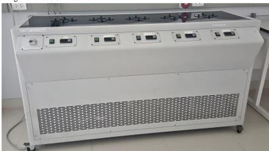
Figure 1. Apparatus for Pour Point Test
